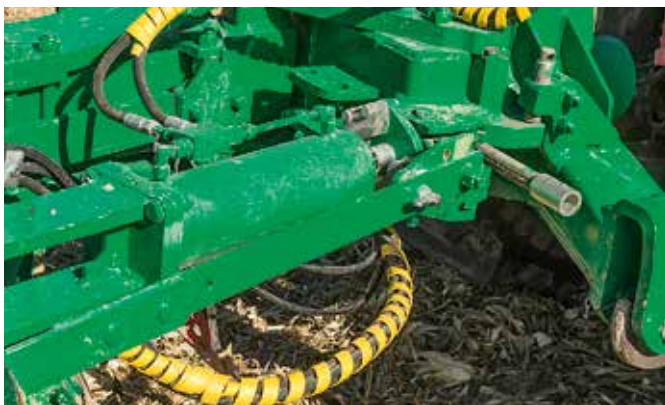
Am Rahmenschenkelzylinder wird die Zuglinie durch Anschlagplatten angepasst.
