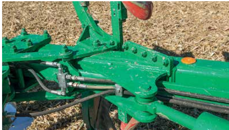
Die mit 60 cm Durchmesser großen Scheibenseche haben auch auf Maisstrohflächen verstopfungsfrei gearbeitet (links). Typisch für die Titan-Baureihe sind die wartungsfreien Körperlagerungen der Schnittbreitenverstellung sowie der geflanschte Rahmen (oben).
